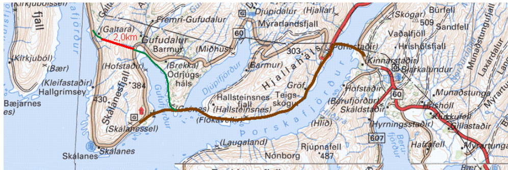
Mynd 45. Þverun þriggja fjarða í Breiðafirði og hugsanleg enn frekari stytting með jarðgöngum undir Skálanesfjall.
